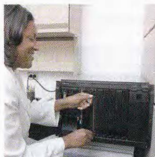
Un BladeCenter S s'installe dans un bureau. Le châssis s'alimente en 220 V.
